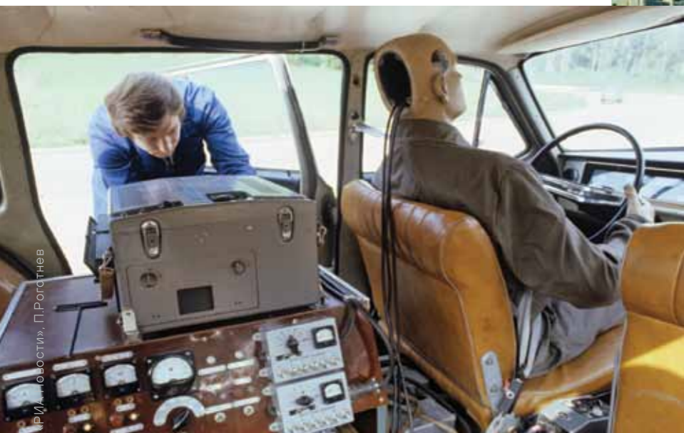
Первые краш-тесты на полигоне представляли собой столкновение автомобиля с неподвижным препятствием
